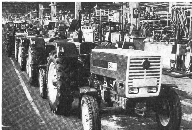
Des tracteurs Steyr de la série Plus, entièrement montés, quittent la chaîne de montage de l'usine de Steyr.
