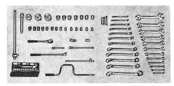
L'outillage de base (clés à fourches, clés à douilles, clés à anneaux, etc.) . . .
