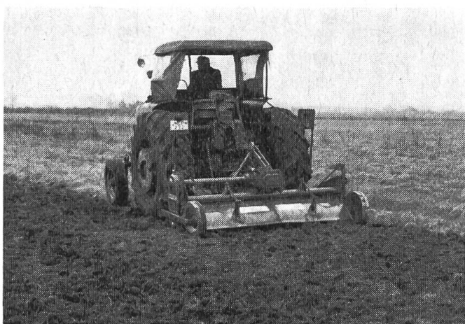
Fig. 1: Aspect du cultivateur rotatif Krone à bèches à commande latérale dont la largeur de travail est de 3 m.
