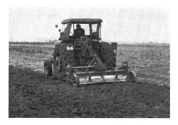
Fig. 1: Aspect du cultivateur rotatif Krone à bêches à commande latérale dont la largeur de travail est de 3 m.
