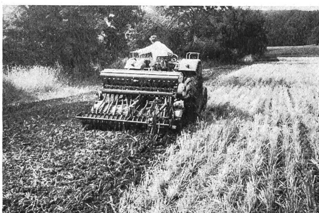
Fig. 3: Ameublissement-ensemencement en un seul passage (pour une culture dérobée), sans labour préalable, à l'aide d'une fraiseuse-semeuse.
