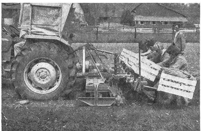
Fig. 5: Ameublissement-plantation simultané (pour une culture de pommes de terre), sur un champ labouré, avec une herse à toupies et une plan-teuse à plusieurs éléments.
