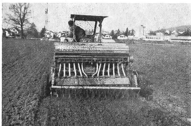
Fig. 2: Fraiseuse-semeuse à laquelle est attelé un rouleau émotteur du type à disques espacés. La profondeur de travail est réglée ici par des roulettes d'appui.
