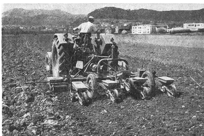
Fig. 6: Ameublissement-ensemencement simultané (pour une culture de maïs), après labour, en utilisant une herse à toupies et une semeuse mono-graine à éléments multiples.
