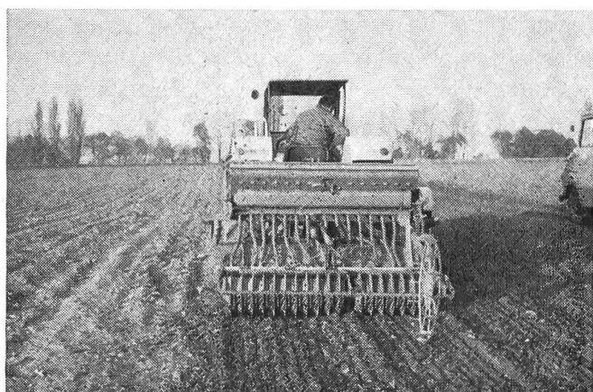
Fig. 1: Fraiseuse-semeuse à laquelle est accouplé un rouleau émotteur du type à disques rapprochés. Ce rouleau sert également à régler la profondeur de travail.
