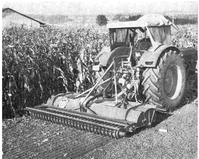
Fig. 2: Enfouissement des tiges de maïs sèches avec une fraiseuse dont la profondeur de travail est réglée avec précision et de manière uniforme par un rouleau émotteur porteur.
