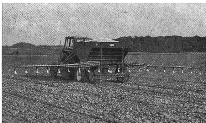
Fig. 3: Sur le distributeur d'engrais «Bögballe» prévu pour de grandes superficies, le dispositif doseur est entraîné par des roues. La distribution du fertilisant se fait en revanche pneumatiquement à l'aide d'un ventilateur actionné par la prise de force du tracteur.
