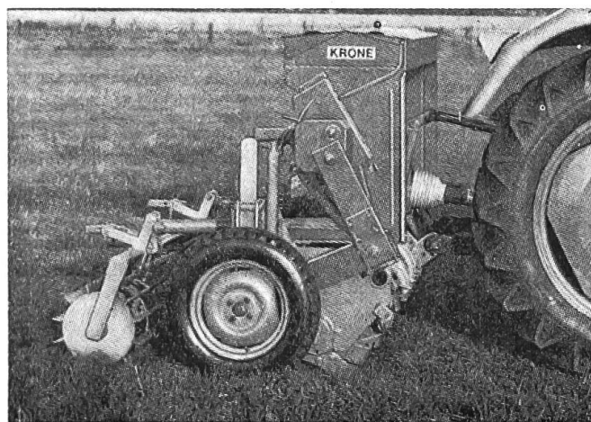
Fig. 2: Aspect de la fraiseuse-semeuse «Krone». Les tubes de descente peuvent être fixés devant ou derrière le rotor de la fraiseuse à lames.
