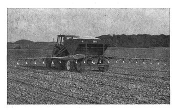
Fig. 3: Sur le distributeur d'engrais «Bögballe» prévu pour de grandes superficies, le dispositif doseur est entraîné par des roues. La distribution du fertilisant se fait en revanche pneumatiquement à l'aide d'un ventilateur actionné par la prise de force du tracteur.
