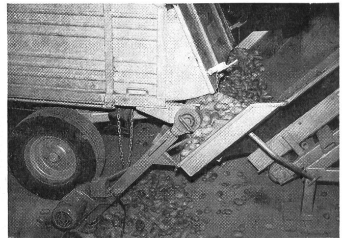
Fig. 4: Un tapis déchargeur avec cylindre enrouleur et groupe motopropulseur utilisé avec une remorque ordinaire à caisse permet également de déverser les pommes de terre directement sur le ruban d'alimentation du calibre. Comme la vitesse d'avancement de ce tapis est réglable (par variateur), la quantité de tubercules déchargée peut être exactement dosée.
