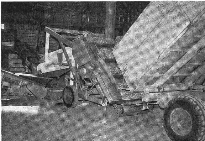
Fig. 2: Un véhicule de récolte à caisse basculant vers l'arrière offre la possibilité de décharger les pommes de terre directement sur le ruban d'alimentation du calibre. Le système régularisant la sortie des tubercules est constitué par une ouverture à clapet pratiquée dans l'hayon arrière (1) et une tôle de retenue placée à l'extrémité arrière de la caisse (2) (voir la Fig. 3).
