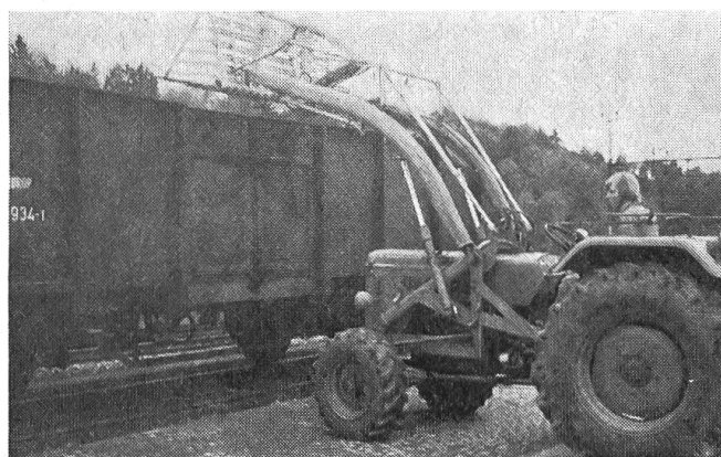
Fig. 4: Un chargeur hydraulique frontal peut être également employé avec succès pour le chargement des wagons à hauts panneaux.
