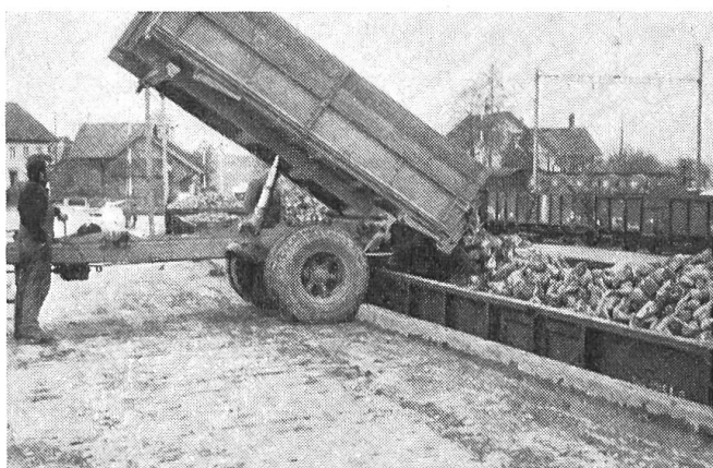
Fig. 7: Une rampe de chargement surélevée offre des conditions favorables pour le vidage des remorques à caisse à basculage arrière de même que des remorques à caisse fixe équipées de chaînes transporteuses à barrettes ou d'un fond mouvant.
