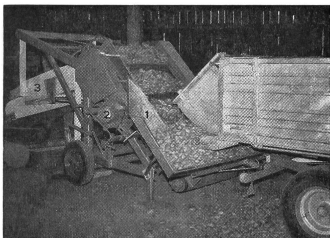
Fig. 5: Aspect du calibreur «Cheveux» utilisé lors des expérimentations. On distingue la très large trémie de remplissage (1), le moteur électrique d'entraînement avec variateur de vitesse (2) et le coffre de calibrage (cribles à mailles carrées) avec le nettoyeur (grille oscillante éliminant la terre) (3).
