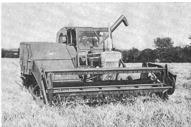
Aspect de la nouvelle moissonneuse-batteuse - JF - du type MS 105 prévue pour être accouplée à un tracteur d'une puissance minimale de 50 ch et entraînée par sa prise de force (540 tr/mn).
