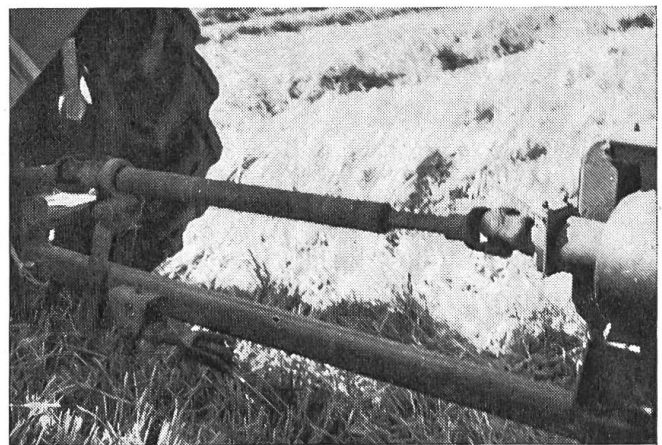
Fig. 7: Des machines utilisées en commun ne doivent pas comporter de risques d'accidents déjà du simple fait qu'elles ne sont pas pourvues des équipements et dispositifs de protection indispensables. Un arbre de transmission à cardans convenablement isolé (2 tubes coulissants sur l'arbre intermédiaire, 1 entonnoir sur chacun des joints de cardan, 1 tôle sur les extrémités de l'arbre d'entrée et de l'arbre de sortie) représente l'ABC de la prévention des accidents. En outre, il est tout aussi important que le conducteur du tracteur jouisse d'une bonne santé et ait la vigueur physique nécessaire.
