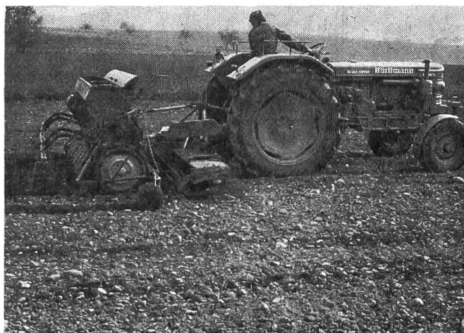
Fig. 2: Emploi simultané d'une herse à toupies et d'un semoir en vue de réaliser en un seul passage, sur un sol labouré, la préparation du lit de germination et l'ensemencement (céréales, par exemple).
