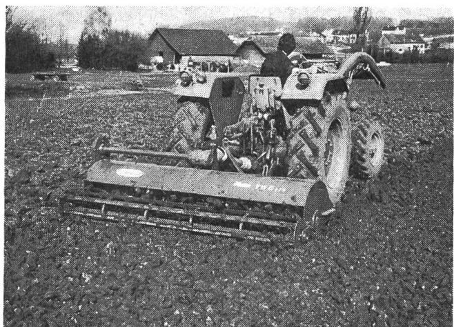
Fig.3: Une herse à étoiles oscillantes complétée par un rouleau émotteur à barres transversales montées en hélice convient particulièrement bien pour préparer les lits des semences et des plants dans les terres qui se tassent difficilement.
