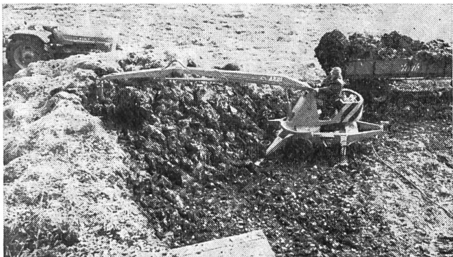
Fig. 12: La grue hydraulique agricole du modèle KMF 417 vue à l'œuvre lors des mesurages pratiques effectués.
