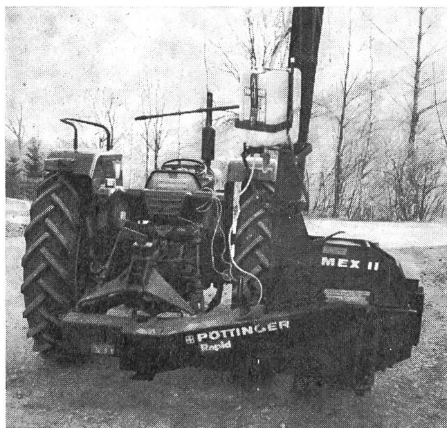
Fig. 4: Cueilleur-broyeur d'épis de maïs pourvu d'un doseur d'acide «LTI», qui est un appareil peu coûteux. Avec un tel matériel, le dosage de l'acide propionique peut être effectué de manière aussi régulière qu'avec un appareil doseur de prix bien plus élevé. Il va sans dire qu'un réservoir d'une contenance de 40 à 50 litres devrait se trouver à disposition au cas où l'adjonction d'acide propionique serait supérieure à 1%.
