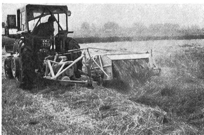
Fig. 2: Nouvelle récolteuse de fourrages réalisée sur la base d'études et recherches effectuées par le NIAE. Il s'agit d'un prototype. Cette machine représente en somme une combinaison de la barre de coupe traditionnelle et du tambour à fléaux. Les tiges du fourrage subissant un laminage efficace, le processus de dessiccation se trouve accéléré.
