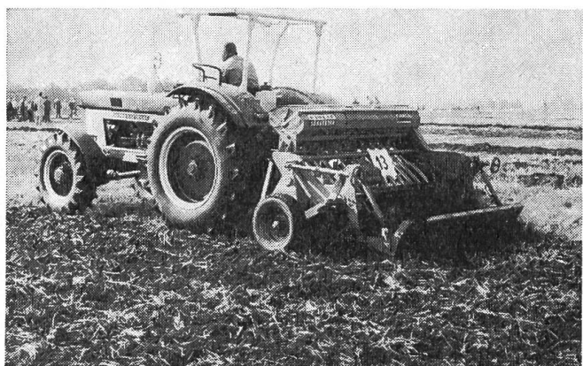
Fig.3: Différents matériels combinés, comportant une fraise et un semoir, furent réalisés et lancés sur le marché au cours de ces dernières années par les fabriques Howard, Krone et Rau. Exigeant une puissance élevée pour leur traction et leur entraînement, ils conviennent particulièrement bien pour les cultures dérobées et les céréales. Ces matériels ameublissent finement un champ et l'ensemencent en un seul passage. Leur prix varie de 7000 à 10 000 marks.
