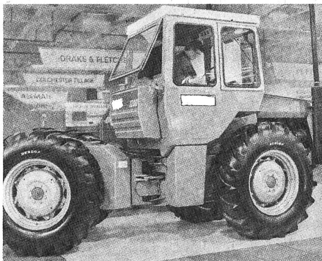
Fig. 2: Machine dotée d'une traction à quatre roues motrices proprement dite (c'est-à-dire à 4 roues d'égale diamètre). On remarquera en outre qu'il s'agit d'un véhicule de type lourd à direction par châssis articulé (pivot central). Par ailleurs, la répartition des poids sur les essieux propulseurs est telle que le couple de cabrage laisse subsister une charge dynamique importante sur les roues avant.
