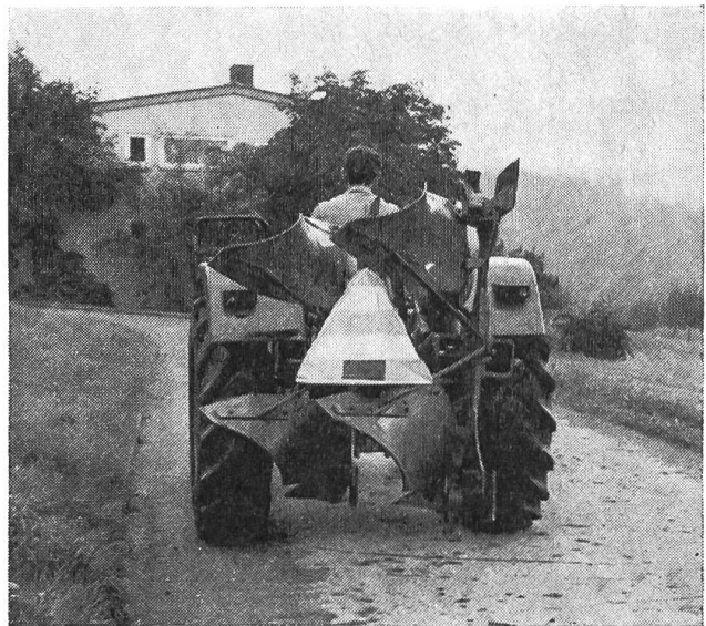
Fig. 1: Aspect du nouveau dispositif de signalisation à raies rouges et blanches d'à peu près 10 cm de large exigé par l'article 35, alinéa 4, de l'Ordonnance fédérale sur la construction et l'équipement des véhicules routiers. Sa surface de projection est d'environ 1000 cm 2 . Il doit être muni en outre de catadioptres ou d'un revêtement réfléchissant.
