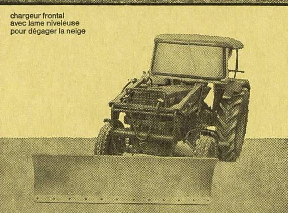
chargeur frontal avec lame nivelleuse pour dégager la neige
