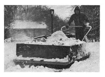
Le véhicule Hover-Pallet à sustentation par coussin d'air sous pression glisse à faible hauteur sur la neige, la glace, les terrains marécageux et les champs détrempés. Il est utilisé ici pour le déblaiement de la neige. Le moteur ne sert qu'à entraîner le ventilateur. Le déplacement du véhicule se fait par poussée ou traction manuelle.
