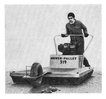
Aspect de l'aéroglisseur terrestre Hover-Pallet. Il comporte pour l'essentiel une plate-forme de charge antidérapante en plastique stratifié renforcé par de la fibre de verre sur laquelle sont montés: un ventilateur, le moteur d'entraînement du ventilateur, un guidon, une roue directrice, deux patins et une jupe à éléments multiples en matériau souple.
