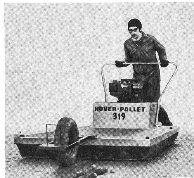
Aspect de l'aéroglisseur terrestre Hover-Pallet. Il comporte pour l'essentiel une plate-forme de charge antidérapante en plastique stratifié renforcé par de la fibre de verre sur laquelle sont montés: un ventilateur, le moteur d'entraînement du ventilateur, un guidon, une roue directrice, deux patins et une jupe à éléments multiples en matériau souple.
