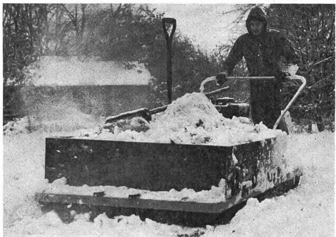
Le véhicule Hover-Pallet à sustentation par coussin d'air sous pression glisse à faible hauteur sur la neige, la glace, les terrains marécageux et les champs détremplés. Il est utilisé ici pour le déblaiement de la neige. Le moteur ne sert qu'à entraîner le ventilateur. Le déplacement du véhicule se fait par poussée ou traction manuelle.
