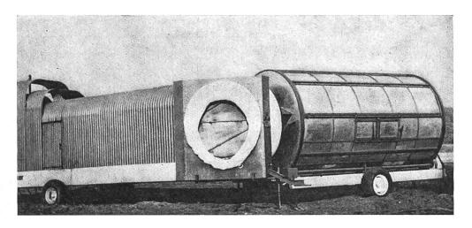
conduit central du récipient cylindrique utilisé comme tambour de séchage et parvient ainsi à la masse de fourrage à déshydrater. Afin d'obtenir une dessiccation rapide et uniforme de cette masse, le tambour est mis en rotation lente avec sa charge. La quantité de fourrage à traiter que contient ce dernier donne environ 750 kg de produit sec. Suivant le taux d'humidité du fourrage introduit dans le tambour (ce taux doit se situer entre 65 et 80 %), la durée du séchage peut repré-
