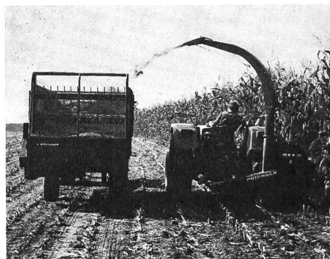
Fig. 3: Faucheuse-hacheuse-chargeuse Pöttinger de type portée pour la récolte du maïs. Le véhicule de récolte de même marque à produits hachés qui roule en parallèle comporte un ruban transporteur transversal utilisé pour le déchargement du fourrage soit dans la trémie d'un transporteur pneumatique, soit sur un ruban élévateur, soit directement dans la mangeoire.
