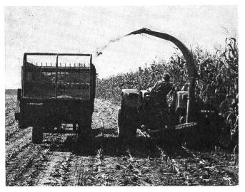
Fig. 3: Faucheuse-hacheuse-chargeuse Pöttinger de type porté pour la récolte du maïs. Le véhicule de récolte de même marque à produits hachés qui roule en parallèle comporte un ruban transporteur transversal utilisé pour le déchargement du fourrage soit dans la trémie d'un transporteur pneumatique, soit sur un ruban élévateur, soit directement dans la mangeoire.
