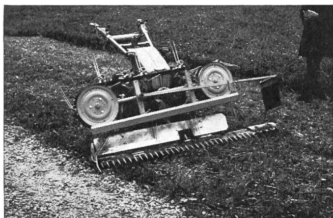
Fig. 1: Aspect du nouveau dispositif andaineur pour motofaucheuses réalisé par la fabrique Rapid. Ses principes de construction et de fonctionnement sont pratiquement ceux du râteau-faneur à chaînes avec peignes souples. Il était présenté par M. Wepfer, chef du département des essais et recherches. Des doigts tronqués (sans pointe) ont été fixés à une extrémité de la barre de coupe afin d'éviter le bourrage de cette dernière.
