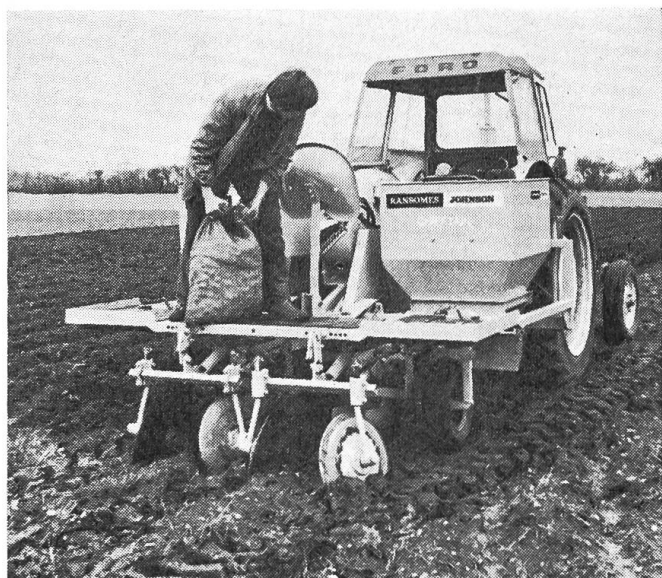
Fig.4: Planteuse de pommes de terre automatique anglaise pourvue d'un nouveau système de distribution à dispositif d'alimentation constitué d'une trémie doseuse à fond incliné vibrant et d'un ruban distributeur en forme de V. Cette machine permet de travailler à des vitesses d'avancement élevées de l'ordre de 6 à 10 km/h.
