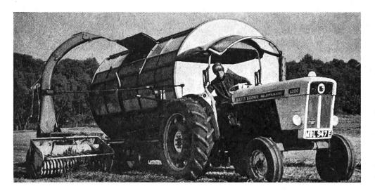
Fig. 9: Remorque spéciale à récipient cylindrique couché à fourrages qu'une ramasseuse-hacheuse-chargeuse remplit d'herbe ou de préfané. A la ferme, ce récipient sera raccordé à un générateur d'air chaud. Animé d'un lent mouvement de rotation, il fonctionnera alors comme tambour de séchage.
