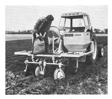
Fig. 4: Planteuse de pommes de terre automatique anglaise pourvue d'un nouveau système de distribution à dispositif d'alimentation constitué d'une trémie doseuse à fond incliné vibrant et d'un ruban distributeur en forme de V. Cette machine permet de travailler à des vitesses d'avancement élevées de l'ordre de 6 à 10 km/h.
