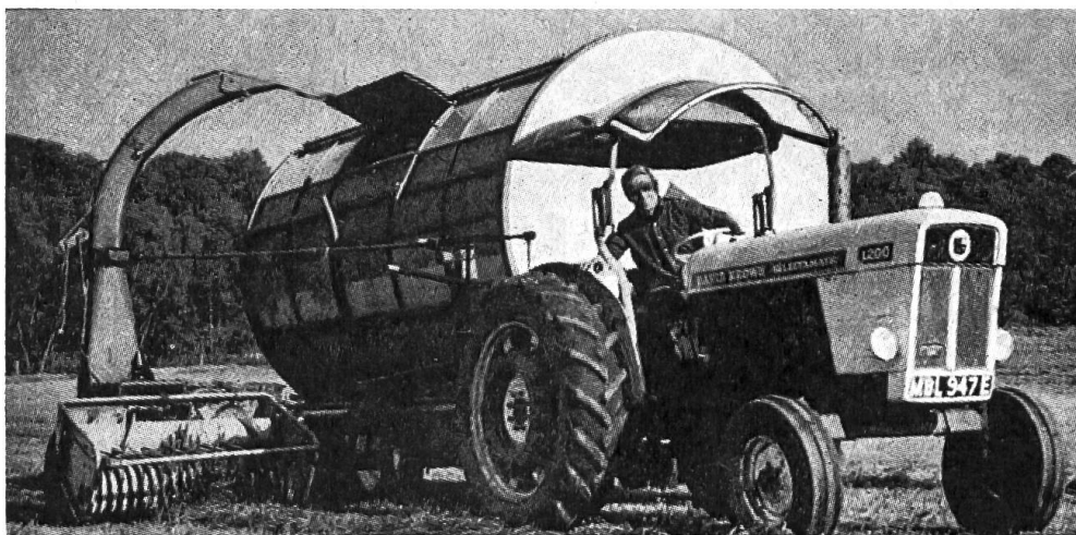
Fig. 9: Remorque spéciale à récipient cylindrique couché à fourrages qu'une ramasseuse-hacheuse-chargeuse remplit d'herbe ou de préfanée. A la ferme, ce récipient sera raccordé à un générateur d'air chaud. Animé d'un lent mouvement de rotation, il fonctionnera alors comme tambour de séchage.
