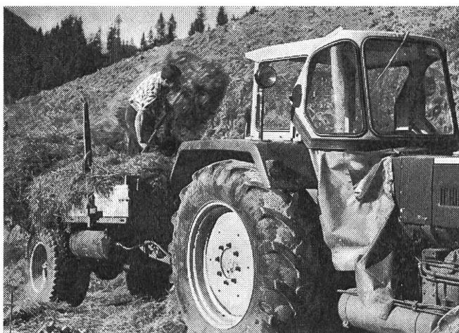
Fig. 4: Remorque forestière employée avec un tracteur agricole. A noter l'installation de freinage à air comprimé de la remorque et la cabine de sécurité du tracteur.
