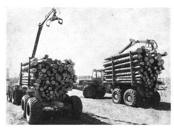
Fig. 3: Tracteur à chenilles avec remorque à pneus (à gauche) et tracteur porteur à articulation centrale (à droite) utilisés pour le débardage des billons.
