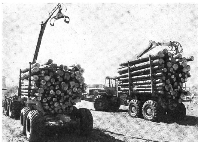
Fig. 3: Tracteur à chenilles avec remorque à pneus (à gauche) et tracteur porteur à articulation centrale (à droite) utilisés pour le débardage des billons.
