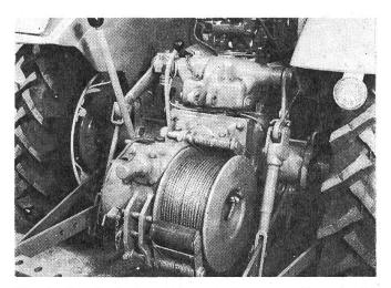
Fig. 1: Treuil de type léger prévu pour être monté sur un tracteur agricole.
