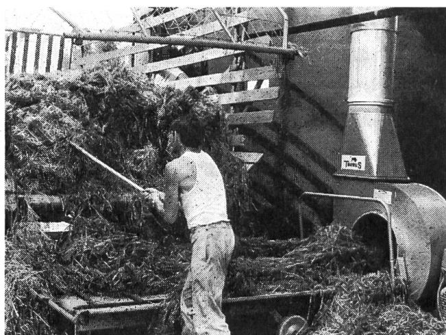
Fig. 4: Un outil de déchargement maniable et léger (croc), ainsi que du fourrage coupé court, facilitent le déchargement du produit et accroissent le rendement de travail du transporteur (élévateur) semi-pneumatique.
