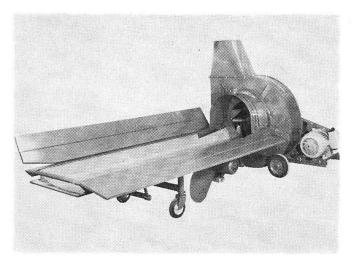
Fig. 1: Transporteur (élévateur) semi-pneumatique avec tablier d'alimentation.
