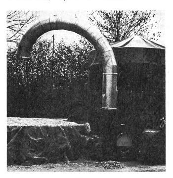
Fig. 5: Transporteur (élévateur) semi-pneumatique dont l'orifice d'aspiration a été partiellement obturé en vue du transport d'épis de maïs broyés.
