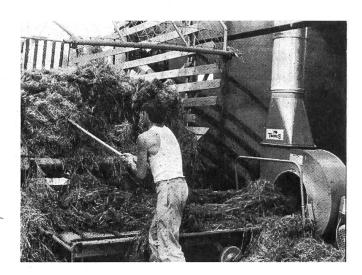
Fig. 4: Un outil de déchargement maniable et léger (croc), ainsi que du fourrage coupé court, facilitent le déchargement du produit et accroissent le rendement de travail du transporteur (élévateur) semipneumatique.
