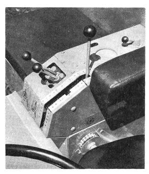
Organes de commande de la moissonneuse-batteuse M 1250 Hydromat. Au premier plan, on distingue le levier de commande pour l'avance, l'arrêt et le recul de la machine.
