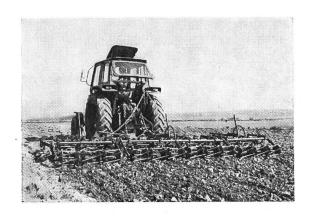
Le nouveau vibroculteur -JF- à largeur de travail variable exécutant la préparation du sol au printemps.
