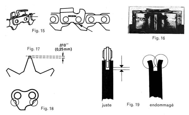
Fig. 15: Remplacement simultané du maillon d'assemblage et du maillon-gouge puis limage correctif de la surface de frottement (base des maillons). Fig. 16: Pignon d'entraînement de chaîne coupante présentant des défectuosités.
