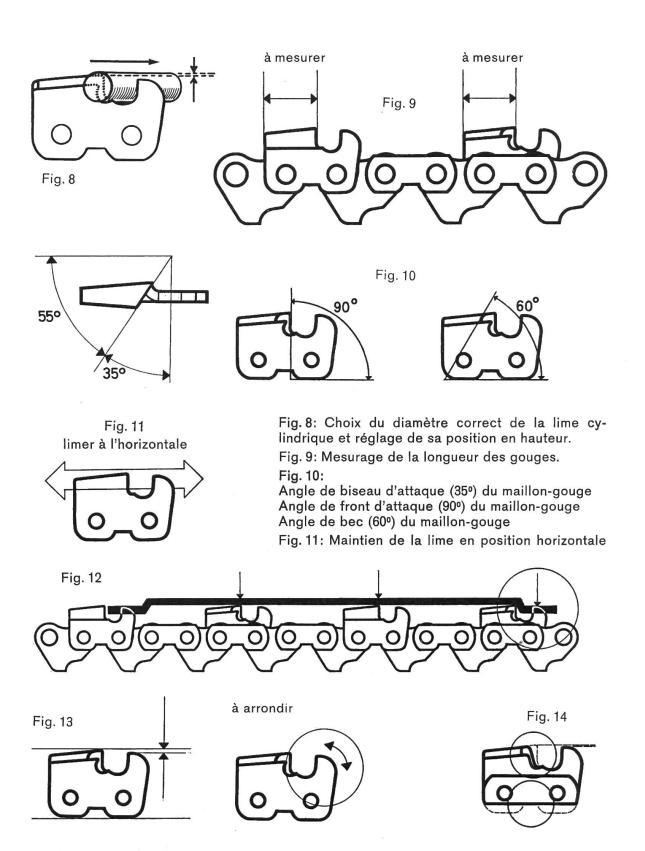
Fig. 12 et 13: Retouche des talons (ils limitent la profondeur à laquelle les gouges s'engagent dans le bois)
