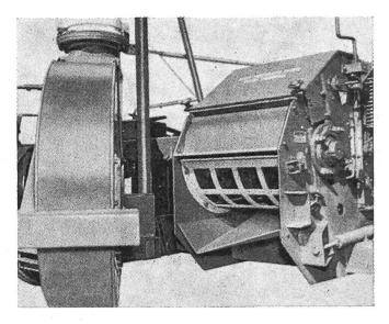
Fig. 5: Le haylage obtenu avec la grille d'affinage à perforations carrées est tronçonné régulièrement à la bonne longueur. Il s'entasse dans les silostours hermétiques sans former de poches d'air. Ses particules uniformes assurent un meilleur fonctionnement de la désileuse. D'autre part, les animaux ont davantage d'appétence pour un tel fourrage à forte teneur en matière sèche.
