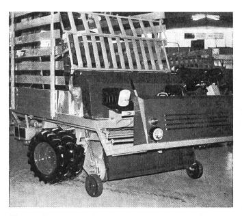
Fig. 9: Cette autochargeuse automotrice à moteur sous plancher et tambour ramasseur monté à l'avant comporte quatre roues directrices.
