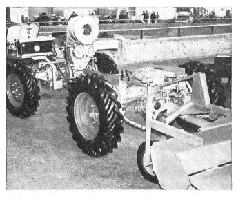
Fig. 3: Il est possible d'équiper un char automoteur ou une autochargeuse automotrice d'un treuil du type cabestan et d'un dispositif de relevage hydraulique, comme on le voit ici. Les jantes des roues de ce véhicule ont un diamètre de 18 pouces (au siège des pneus).
