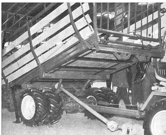
Fig. 2: Ce char automoteur est équipé d'un distributeur du type centrifuge qui peut être employé pour épandre non seulement les engrais du commerce mais aussi le sable et le sel (entretien des routes et chemins vicinaux).
