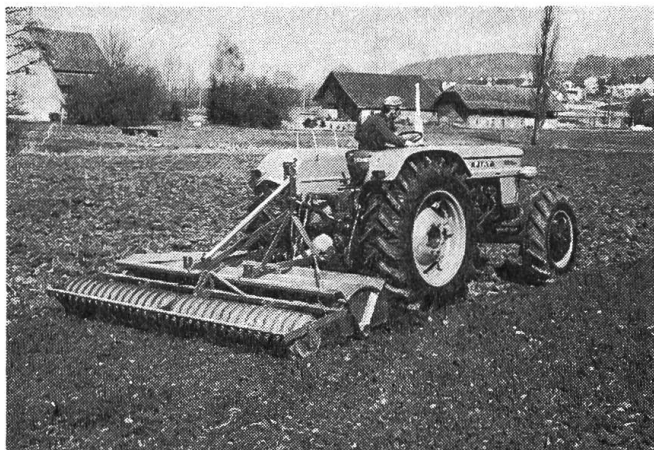
Fig.4: Fraiseuse à lames utilisée en combinaison avec un rouleau émotteur à disques pour la préparation des lits de germination des semences et des plants.
