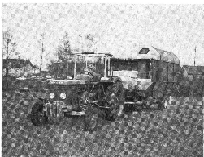
Fig. 1: Remorque chargeuse-hacheuse-déchargeuse munie d'un pick-up. En haut, on distingue la tubulure de raccordement pour la tuyère d'éjection (système Landsberg).
