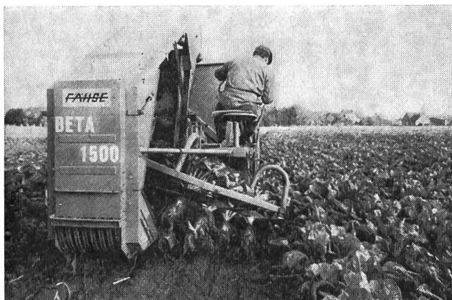
Fig. 2: A l'heure actuelle, la récolte des betteraves fourragères est devenue également possible avec des décolleteuses-arracheuses à trémie collectrice qui déterrent les betteraves, tranchent leur touffe de feuilles en laissant le collet (afin d'éviter la pourriture) et acheminent les racines vers la trémie. La mise en œuvre de ces machines exige toutefois des betteraves peu enterrées et pourvues d'un feuillage abondant.
