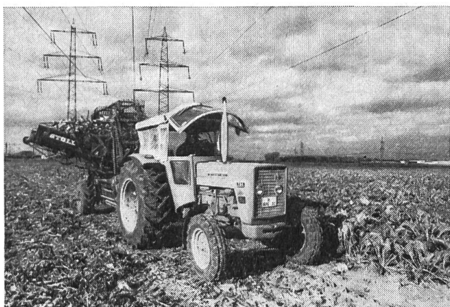
Fig. 1: Grâce à des commandes hydrauliques, la décolleteuse-arracheuse-ramasseuse à un rang avec trémie collectrice n'exige qu'une seule personne de service, soit le conducteur du tracteur. Il s'agit de la machine qu'on emploie toujours le plus pour la récolte des betteraves sucrières. Les arracheuses multirangs, réalisées comme matériels tractés ou automoteurs, sont en effet peu utilisées. A relever que le système de récolte français en trois phases avec la mise en œuvre successive de machines à six rangs (décolleteuse, arracheuse, ramasseuse-chargeuse) a aussi ses partisans.
