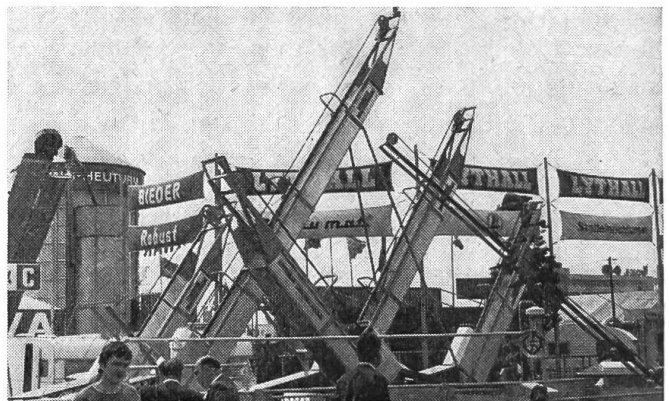
Fig. 8: Elévateurs de types divers prévus pour le remplissage de silos à engrais chimiques.
