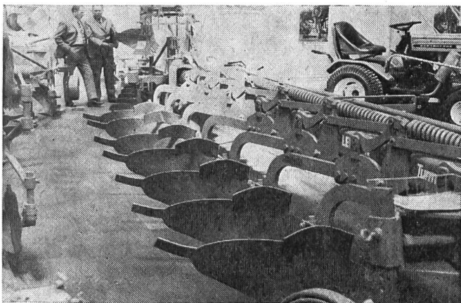
Fig. 4: Aspect d'une charrue déchaumeuse de type lourd à socs multiples. Certaines peuvent comporter jusqu'à douze socs.
