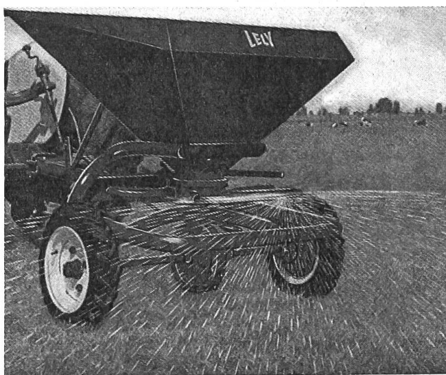
Fig. 6: Distributeur d'engrais centrifuge de type tracté à disque épandeur unique entraîné par l'intermédiaire des roues porteuses.
