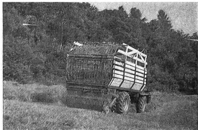
Fig. 2: Le tambour ramasseur d'un char automoteur chargeur se trouve à l'arrière du véhicule. Etant ainsi très accessible, il permet d'alimenter commodément le dispositif chargeur dans les cas où ce dernier doit travailler à poste fixe, c'est-à-dire lorsqu'il s'agit de ramasser le fourrage à la fourche sur des talus impraticables.
