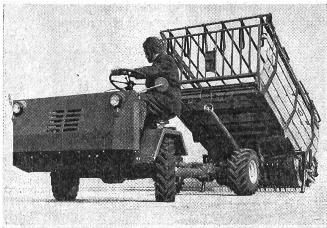
Fig. 1: Sur un char automoteur chargeur, autrement dit équipé d'une caisse amovible d'autochargeuse à fourrages, cette dernière peut être très facilement enlevée pour qu'on fixe un plateau de chargement en lieu et place.
