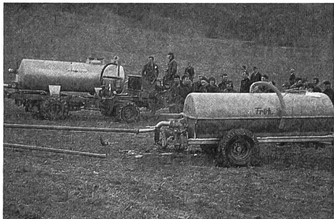
Fig. 5: Aspect de deux machines ayant fait l'objet de démonstrations. A gauche, tonneau à lisier à pompe à liquides (2000 l) monté sur une autochargeuse automotrice à moteur de 40 ch dont on a enlevé les superstructures, le plateau de charge et le dispositif ramasseur-chargeur. A droite, tonneau à lisier avec pompe à déplacement de moyenne pression fixé sur un châssis à deux roues (remorque semi-portée). L'un et l'autre de ces épandeurs sont mis en œuvre pour puriner un terrain en pente au moyen de tuyaux souples.
