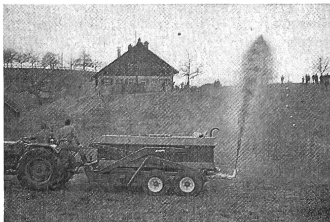
Fig. 3: L'épandeur de lisier à pompe à vis (pompe à liquides) permet de projeter latéralement le fertilisant à grande distance et hauteur à l'aide d'une buse d'épandage (diffuseur) coudée. Un tonneau à lisier d'une contenance de 4000 l a été monté sur cette remorque spéciale. Du point de vue de la prévention des accidents, l'un des démonstrateurs que l'on voit ici ne montre malheureusement pas le bon exemple car il se tient à un endroit dangereux. Des démonstrateurs aussi insoucients ne devraient pas être tolérés lors de démonstrations.
