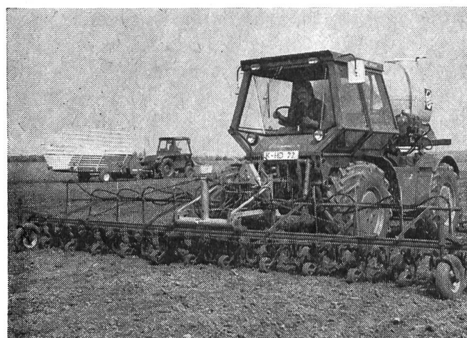
Fig. 2 et Fig. 3: La cabine de sécurité des tracteurs porte-outils Deutz, de conception foncièrement nouvelle, a la forme d'un hexagone à base tronquée et est entièrement vitrée. A ce qu'il paraît, la visibilité totale dont jouit le conducteur lui permet de bien contrôler le travail exécuté tant par les matériels adaptés à l'arrière que par ceux adaptés à l'avant. Un dispositif d'accouplement et désaccouplement rapide automatique, par des cadres triangulaires verticaux s'emboîtant l'un dans l'autre, permet d'atteler et dételer facilement tous les instruments ou machines de travail pourvus du cadre triangulaire correspondant. D'autre part, des raccords hydrauliques ont été prévus en nombre suffisant.
