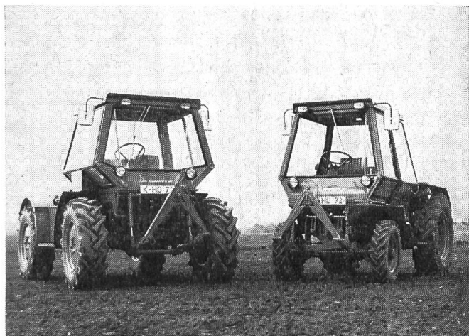
Fig.1: Les deux nouveaux tracteurs porte-outils Deutz à moteur central ont été réalisés d'après le système Intrac, lequel représente une amélioration fondamentale du principe de construction du tracteur agricole. Ces machines de traction et de travail sont: à gauche, l'Intrac 2005 qui comporte un moteur de 80 ch à 5 cylindres et une transmission hydrostatique; à droite, l'Intrac 2002 qui a été équipé d'un moteur de 50 ch et construit en partie avec des organes et pièces des tracteurs Deutz (moteur, transmission, pont arrière) de la série 06. Ces deux modèles vont être fabriqués sous peu en séries plus importantes.
