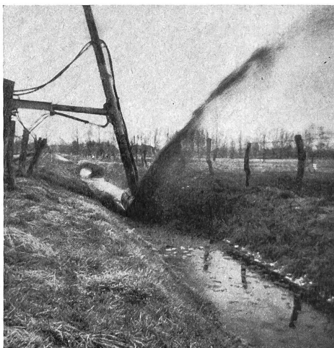
Fig. 4: Aspect d'une cureuse de fossés réalisée en tant que remorque semi-portée et qui a été munie d'une turbine à pales. Cette turbine nettoyeuse peut être complétée par une turbine hacheuse du type à fléaux.
