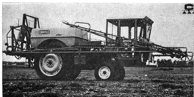
Fig. 8: Sur le pulvérisateur autotracté «Caruelle», le réservoir à bouillie a été placé à l'arrière — soit pratiquement sur l'essieu moteur à roues de grand diamètre — et la cabine du conducteur en position avancée sur l'essieu directeur (bonne visibilité). Ces deux dispositions sont donc rationnelles.
