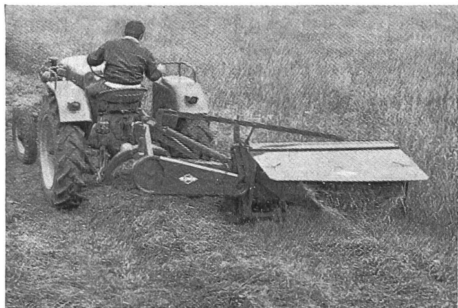
Fig.9: Une faucheuse-conditionneuse lamine et épand le fourrage, ce qui permet d'accélérer considérablement sa dessiccation.
