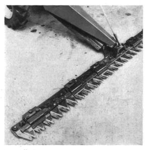
Nouvelle barre de coupe «Universelle» sans doigts permettant un fauchage sans bourrage dans toutes les conditions de fourrage.
