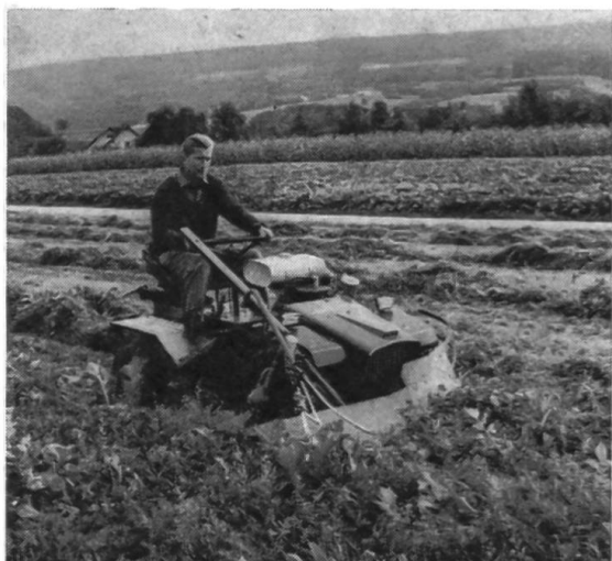
Tractomobil BUCHER M 700 S avec barre de coupe de 190 cm à doigts et appareil andaineur conventionnel.
