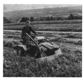
Tractomobil BUCHER M 700 S avec barre de coupe de 190 cm à doigts et appareil andaineur conventionnel.
