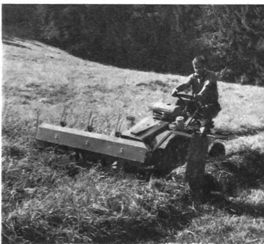
Tractomobil BUCHER M 700 S avec barre de coupe Universelle de 2 m et appareil andaineur à râteau à bande.
