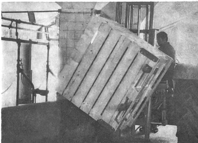
Fig. 4 Déversement des pommes de terre directement dans la mangeoire grâce à une tête rotative à commande hydraulique qui permet de basculer la paloxe de manière progressive et contrôlée. Au cas où des piliers gênent la distribution, l'élévateur doit être pourvu d'un dispositif à commande hydraulique qui permette de déplacer légèrement la fourche porteuse sur le côté.
