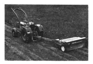
Depuis son apparition sur le marché, le matériel de conception moderne que représente la faucheuse rotative à tambours à lames a connu un succès sans cesse croissant. La Fabrique de machines FAHR S.A., à Gottmadingen (Allemagne), a réalisé récemment une nouvelle faucheuse de ce genre, du type tiré, spécialement des-
