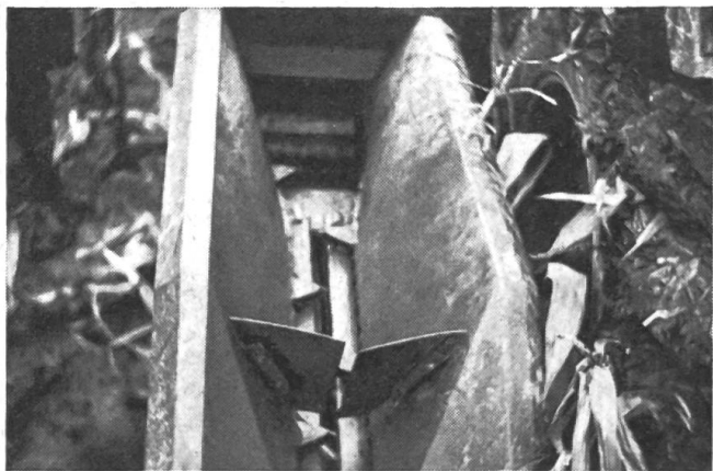
Fig. 2: Il s'agit ici du cueilleur-broyeur d'épis de maïs construit par la fabrique Pöttinger, dont on voit l'organe cueilleur.
