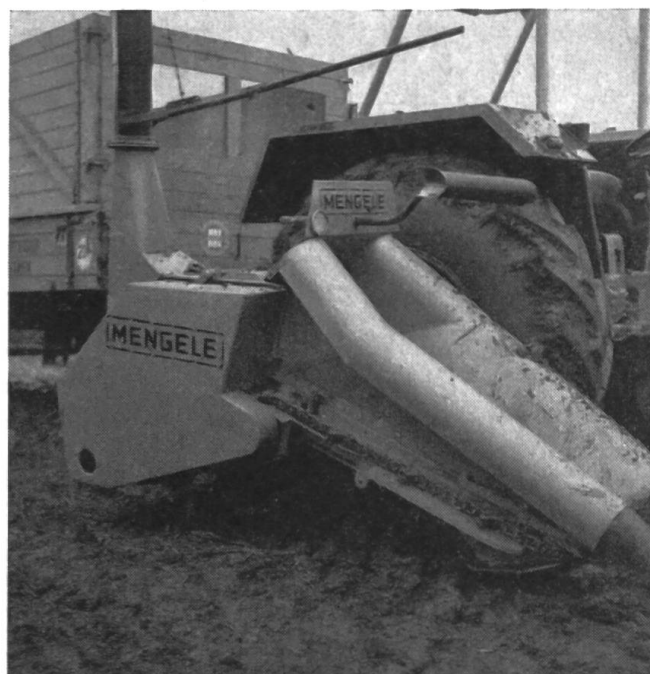
Fig. 1: Aspect du cueilleur-broyeur d'épis de maïs réalisé par la fabrique Mengele. Extérieurement, il ne se différencie guère de la faucheuse-hacheuse-chargeuse de maïs-fourrage portée.
