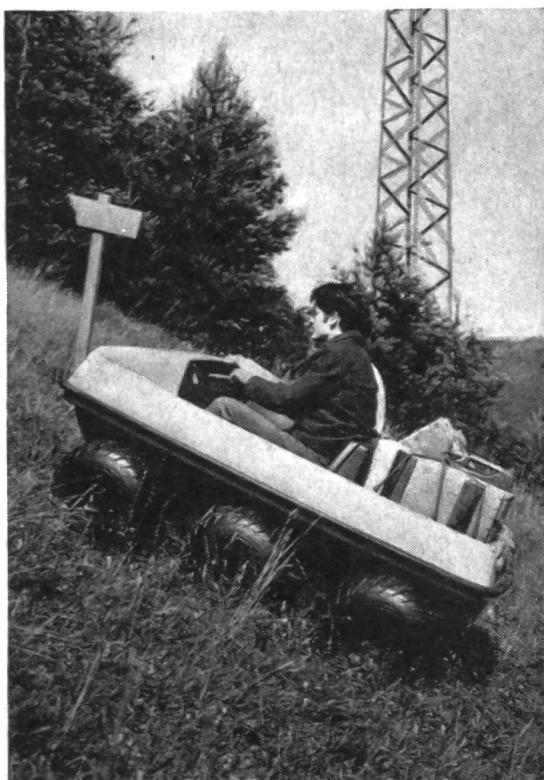
Aspect du véhicule tout-terrain et amphibie «Solo 750» à 6 roues motrices (adhérence totale). Il est équipé d'un moteur de 25 ch DIN et peut rouler à une allure de 60 km/h.
