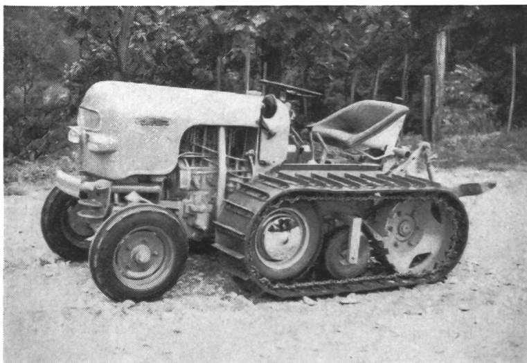
Fig. 2: Aspect du tracteur vigneron interligne à semi-chenilles imaginé et réalisé par un viticulteur en tant que prototype, puis fabriqué ensuite en collaboration par deux ateliers de constructions mécaniques.
