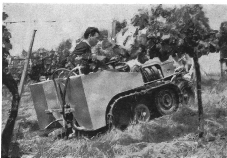
Fig. 4: Utilisation de la même machine avec un pulvérisateur et un réservoir à bouillie pour les traitements antiparasitaires et anticryptogamiques.
