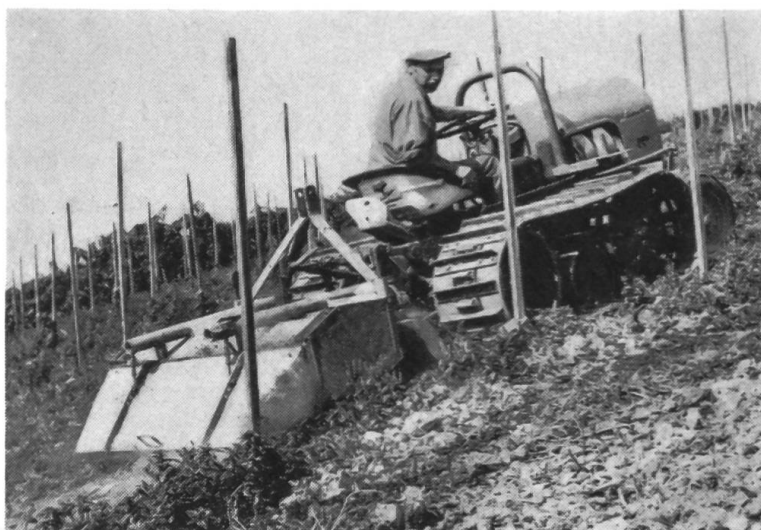
Fig. 3: Emploi de ce tracteur à semi-chenilles avec une fraise à lames pour la préparation physique du sol dans un vignoble en pente.
