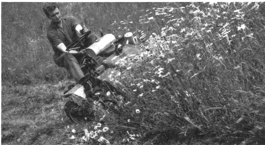
Fig.5 et 6: Aspect de la faucheuse-faneuse-andaineuse automotrice de fabrication suisse. Cette machine, à buts d'utilisation multiples, convient particulièrement bien pour l'exécution de travaux sur des terrains déclives. D'autre part, elle représente le seul matériel de fenaison qui permette à un conducteur assis d'effectuer, jusqu'à 60 % d'inclinaison, le fauchage selon le sens des courbes de niveau et l'andainage selon le sens de la pente.
