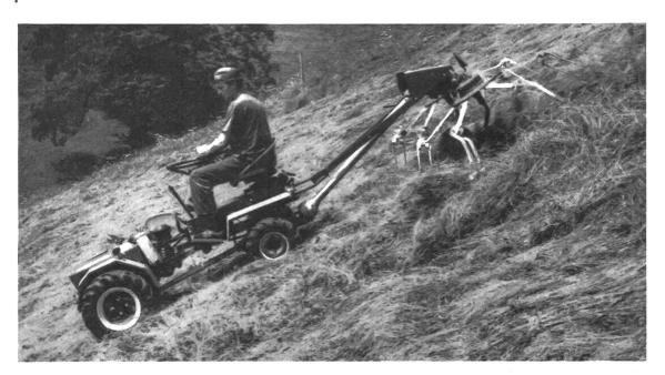
Fig. 9: La faucheuse-faneuse-andaineuse automotrice suisse n'arrive toutefois à travailler que sur des champs d'un taux d'inclinaison maximal de 40 à 45 % quand on l'emploie avec une faneuse à toupies.
