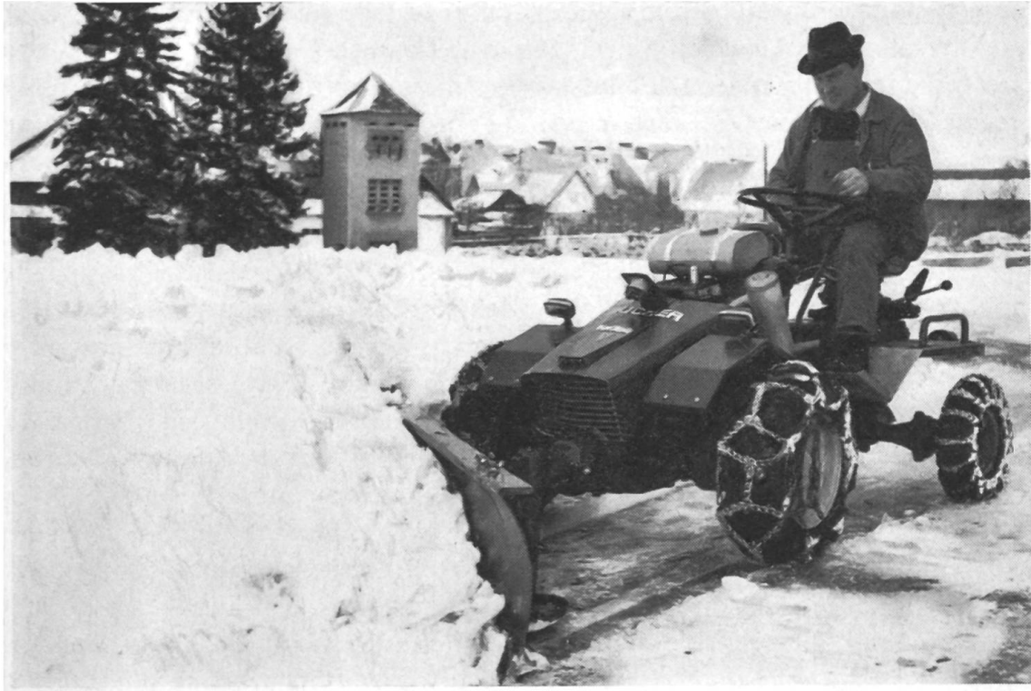
Fig. 10: En hiver, l'adaptation d'une lame déblayeuse à l'avant de cette machine très maniable permet de déneiger parfaitement bien la ferme et ses abords, les chemins de parcs, les trottoirs, etc.
