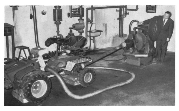
Fig. 11: La machine en question a aussi fait l'objet d'essais techniques rigoureux dans les laboratoires de l'Institut fédéral autrichien d'essai et d'expérimentation de matériels agricoles (BVPA). A ce banc d'essai, qui comporte un frein hydraulique, les deux prises de force ont tourné pendant plus de 100 heures à 75 % de charge de la puissance nominale du moteur.
