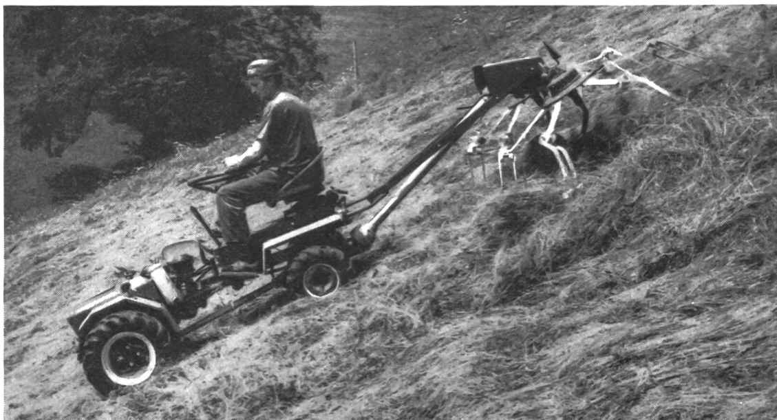
Fig. 9: La faucheuse-faneuse-andaineuse automotrice suisse n'arrive toutefois à travailler que sur des champs d'un taux d'inclinaison maximal de 40 à 45 % quand on l'emploie avec une faneuse à toupies.
