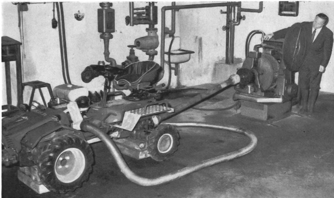
Fig. 11: La machine en question a aussi fait l'objet d'essais techniques rigoureux dans les laboratoires de l'Institut fédéral autrichien d'essai et d'expérimentation de matériels agricoles (BVPA). A ce banc d'essai, qui comporte un frein hydraulique, les deux prises de force ont tourné pendant plus de 100 heures à 75 % de charge de la puissance nominale du moteur.
