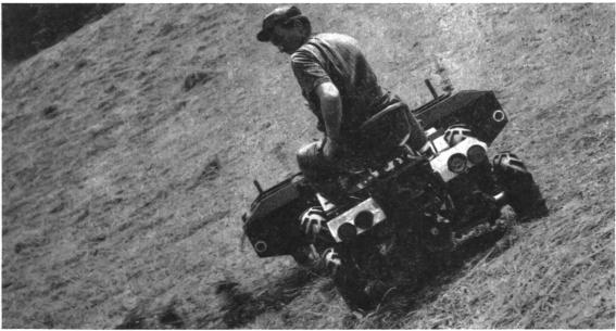
Fig. 7 et 8: Vue de la même machine, à grande capacité de travail, qui est équipée ici d'un râteau-faneur à courroies trapézoïdales. Sur les terrains inclinés, elle atteint la limite d'emploi de l'autochargeuse autotractée aussi bien lors du fauchage que de l'andainage exécutés suivant le sens de la pente.
