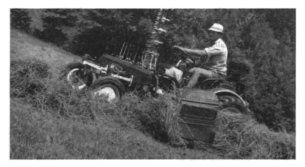
Fig. 4: Vue de la même machine lors de l'andainage du fourrage exécuté selon le sens de la plus grande pente et à la montée.
