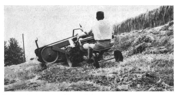
Fig. 2: Sur les champs d'un faible taux d'inclinaison, le chariot-siège pouvait être parfaitement bien utilisé. Pour virer la machine en bout de champ sur un emplacement restreint, il fallait naturellement relever ce chariot.
