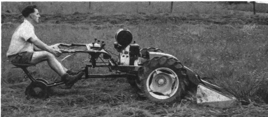
Fig. 1: On avait déjà tenté antérieurement de réduire la pénibilité du travail que représente l'emploi de la motofaucheuse pour la récolte des fourrages en équipant cette machine, tout ou moins en plaine, d'un siège monté sur chariot.
