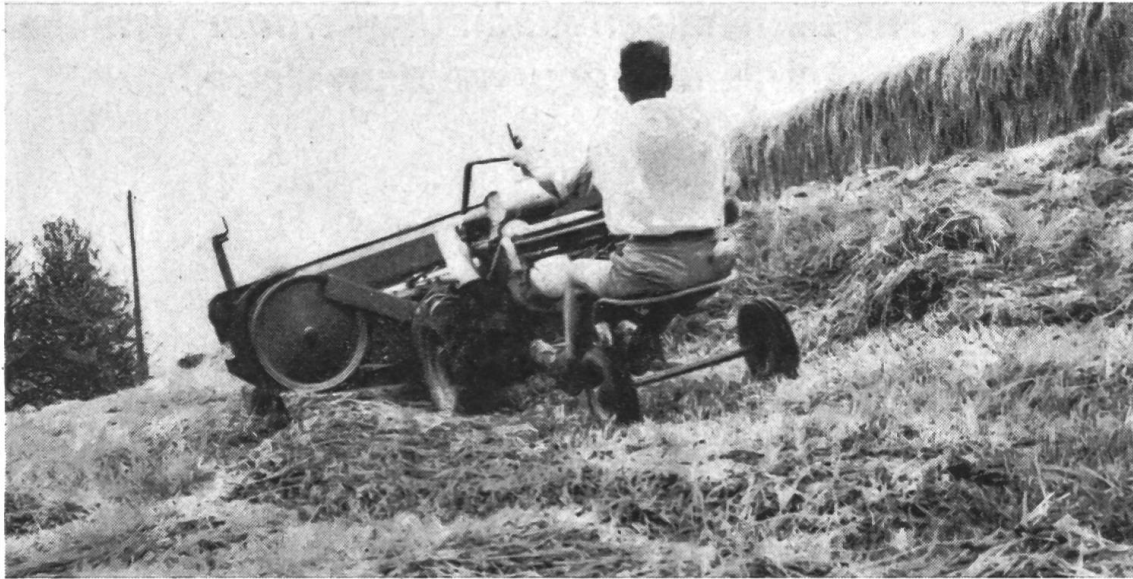
Fig.2: Sur les champs d'un faible taux d'inclinaison, le chiot-siège pouvait être parfaitement bien utilisé. Pour virer la machine en bout de champ sur un emplacement restreint, il fallait naturellement relever ce chiot.
