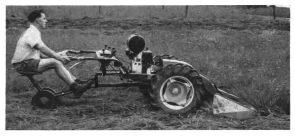
Fig. 1: On avait déjà tenté antérieurement de réduire la pénibilité du travail que représente l'emploi de la motofaucheuse pour la récolte des fourrages en équipant cette machine, tout ou moins en plaine, d'un siège monté sur chariot.
