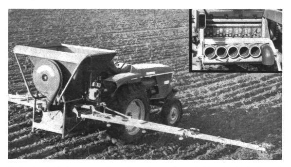
Fig. 7: Le distributeur pneumatique d'engrais que l'on voit ici a été fabriqué par la firme «Nodet-Gougis». Il se compose essentiellement d'organes de répartition qui sont des cylindres à ergots (1), de tubes en plastique de longueur différente (2) et de diffuseurs. A sa sortie, le fertilisant est épandu en nappe.
