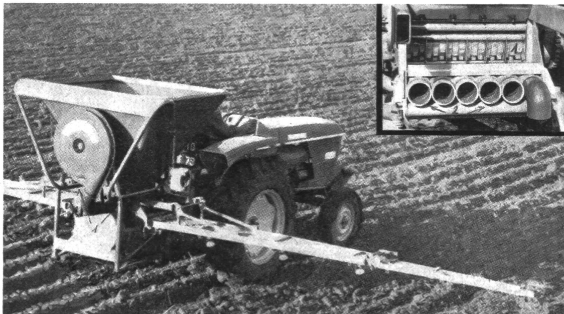
Fig. 7: Le distributeur pneumatique d'engrais que l'on voit ici a été fabriqué par la firme «Nodet-Gougis». Il se compose essentiellement d'organes de répartition qui sont des cylindres à ergots (1), de tubes en plastique de longueur différente (2) et de diffuseurs. A sa sortie, le fertilisant est épandu en nappe.
