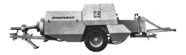
Les presses à haute densité ont fait leurs preuves chez plus de 50 000 agriculteurs et entreprises de battage. En un seul passage, la récolte est ramassée proprement, pressée, liée et, au besoin déchargée directement sur une remorque attelée. De construction robuste, les presses CLAAS peuvent affronter les plus dures conditions. Elles se distinguent par des bottes bien séparées, aux arêtes vives, avec ficelle encastrée. En plus, on est frappe par leur forme élégante, moderne et leur ligne basse.
