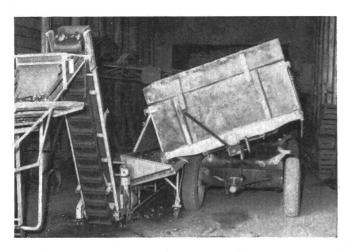
Fig. 4: Déchargement et manutention des pommes de terre au moyen d'un véhicule à caisse basculant sur le côté et d'un ruban transporteur spécial avec clapet de retenue.
