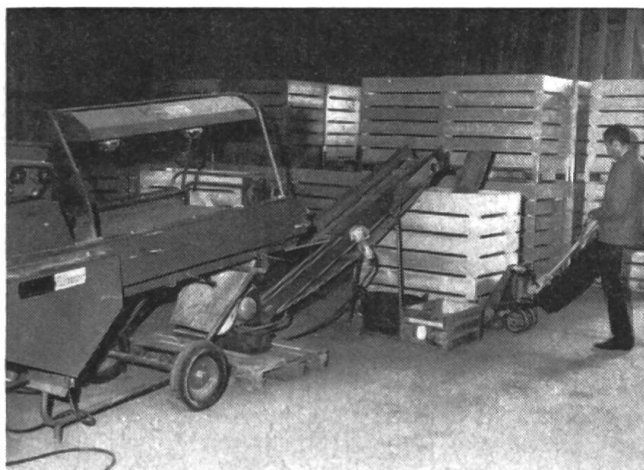
Fig. 7: Précalibrage des pommes de terre sitôt après leur récolte. — Le nombre de paloxes exigées ici est de 35 à 40 % inférieur à celui qui s'avère nécessaire lorsque le remplissage de ces caisses-palettes se fait aux champs avec un produit non trié au préalable.
