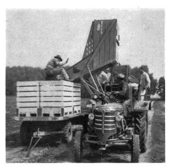
Fig. 2: Arracheuse-ramasseuse de pommes de terre à trémie basculante (machine à récolte totale — Déversement du produit dans des caisses à claire-voie normalisées de grandes dimensions (paloxes).
