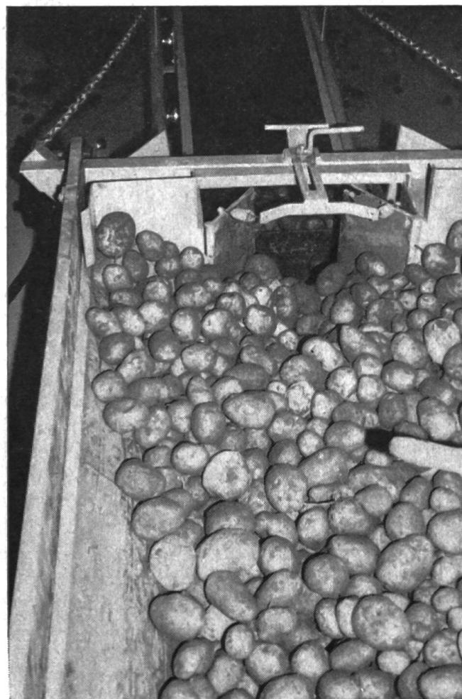
Fig. 5: Vue de près du clapet de retenue du ruban transporteur spécial. Il sert à régulariser la sortie des tubercules, et, par suite, l'alimentation de l'élévateur.
