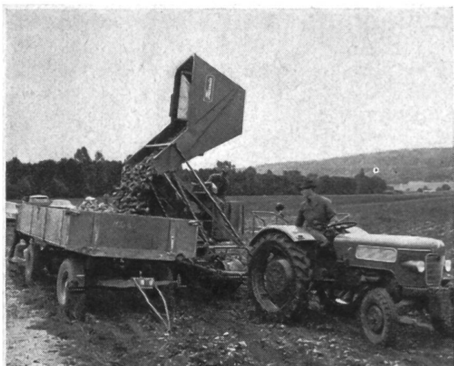
Fig. 1: Arracheuse-ramasseuse de pommes de terre à trémie basculante (machine à récolte totale). — Déversement du produit dans un véhicule à caisse (ridelles et hayons).
