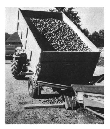
Fig. 3: Déchargement et manutention des pommes de terre à l'aide d'un véhicule à caisse basculant vers l'arrière, d'une trémie surdimensionnée et d'un ruban transporteur.
