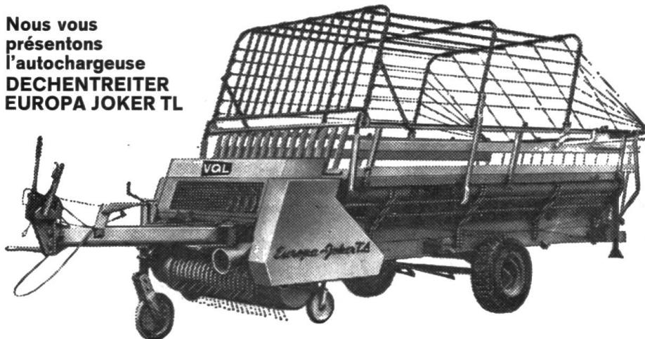
Avec le dispositif de chargement rapide JD. Avec la plate-forme en acier en forme de cuvette avec paroi arrière à triple réglage en hauteur. Dispositif de coupe rabattable jusqu'à 9 couteaux.
