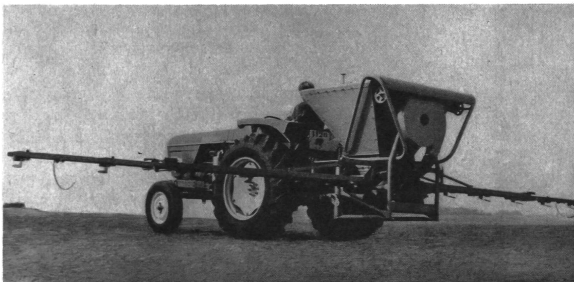
Fig. 1: La forte tendance actuelle à réaliser des matériels capables de travailler de grandes superficies à l'heure a été également constatée au Salon international de la machine agricole de Paris. Le distributeur d'engrais représenté ici peut traiter une bande de terre de 9 m de large. Les parties extérieures de la barre de répartition sont relevées pour les transports sur route.
