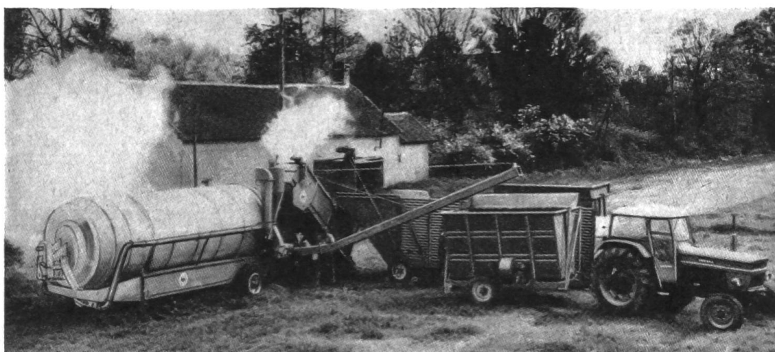
Fig. 7: Aspect d'une déshydrateuse mobile (séchoir à herbe) pourvue d'un groupe électrogène. Cette machine autonome peut être ainsi employée dans la cour de la ferme ou en bordure d'un champ. Son prix est d'environ Fr. 225 000.—.
