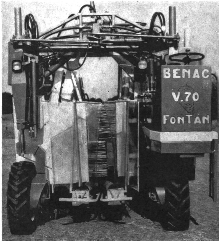
Fig. 10: Aspect d'une machine automotrice à vendanger (vendangeuse). Son principe de fonctionnement est le suivant: les grains (ou les grappes) sont détachés par l'action percutante de plus de 5000 aiguilles animées de mouvements alternatifs (400 à 500 impulsions-minute) et tombent sur des transporteurs qui les déversent dans deux bennes basculantes. Durant ce parcours, les feuilles sont aspirées et évacuées par une soufflerie.
